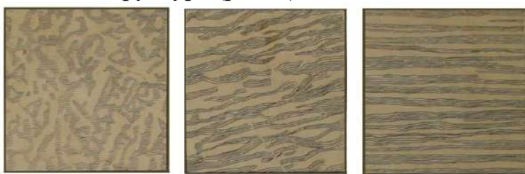
Рис. 4. Образование волокнистого строения в результате вытяжки
