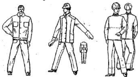
Рис.1. Мужской и женский костюмы для защиты от производственных загрязнений и механических воздействий.
