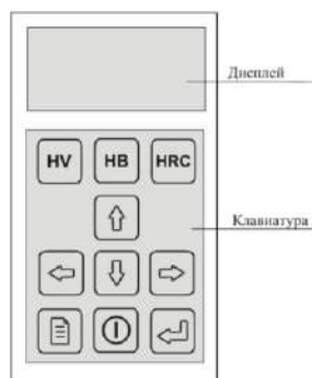
Рисунок 2 – Составные части твердомера
